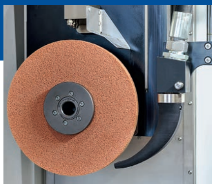
NC制御によるクーラント供給制御と機内内蔵型高圧クーラントノズルによる最適な砥石クーラント
