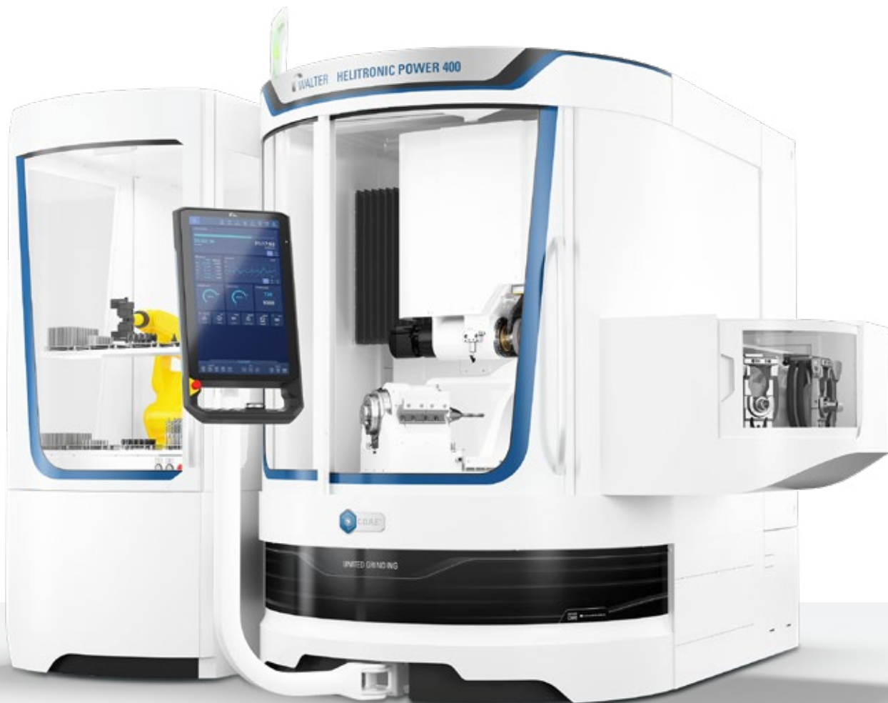
HELITRONIC POWER 400 avec les options changeur de meules (à droite) et robot chargeur (à gauche)
