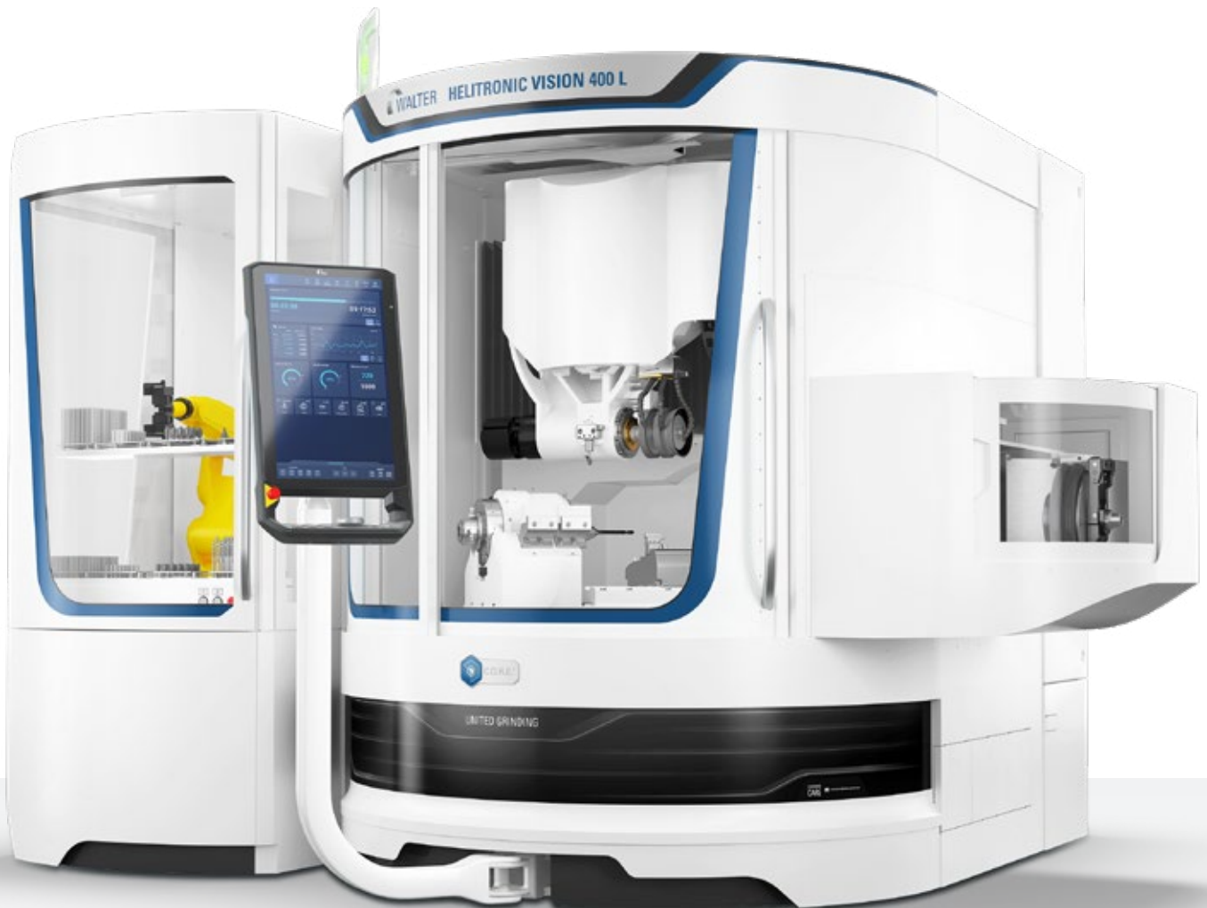
HELITRONIC VISION 400 L 右:砥石交換装置 左:ロボットローダー
